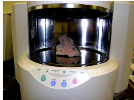
Камера спектрометра EDX-900HS с образцом
