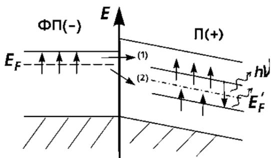
Рис.2. Схема спинового токопереноса из ФП на верхний (сценарий 1) или нижний (сценарий 2) зеэмановский электронный уровень полупроводника. Знаки (-) и (+) полярности напряжения на ФП–П-гетероструктуре
