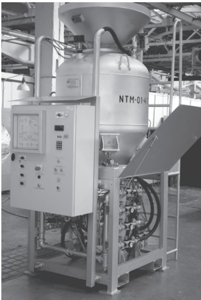
момеханического питателя. В результате в 2001 г. была создана первая инжекционная установка типа НТМ-01, а затем серия усовершенствованных конструкций.
