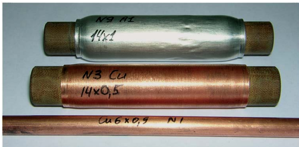
Рис. 16. Экспериментально реализованное расширение проводящих оболочек из алюминия и меди
