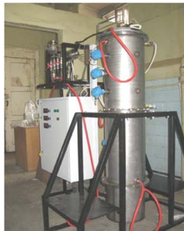
Рис. 49. Установка для получения порошков методами спрей-пиролиза и парогидролиза
