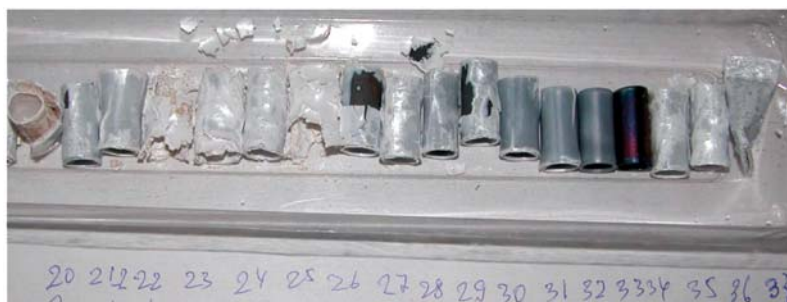
Рис. 50. Образцы, подвергнутые ГТО в смесях с различным содержанием кислорода при температуре 1050 °С
