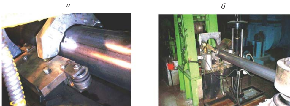
Рис. 39. Установка УМД-101М для магнитной дефектоскопии сварных соединений и тела электросварных труб:
